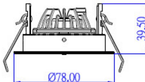
Hocheffizienter LED-Einbaustrahler für Neuinstallation oder als Halogenersatz zum Einbau in abgehängte Decken, kardanisch schwenkbar, mit Hochglanzreflektor und Klarglasscheibe zur einfachen Reinigung, Energieeffizienzklasse A+, mit dimmbarem EVG.
