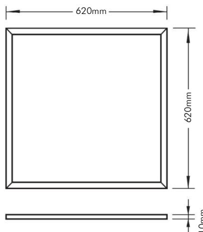
LED-Panel zum Einlegen in Moduldecken mit einem Rastermaß von 625\*625mm oder mit separat erhältlichem Aufbaurahmen. Symmetrische, breitstrahlende Lichtverteilung, geringe Einbautiefe, Entblendung für Bildschirmarbeitsplätze, BAP, UGR<19
